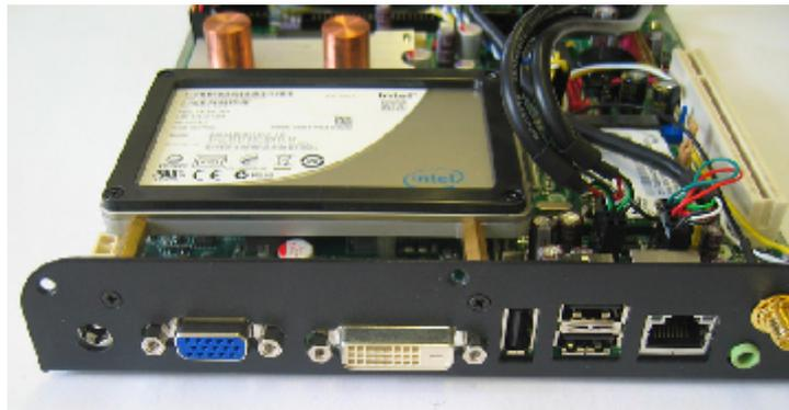
Falls Sie keine SSD verwenden, benötigen Sie das mitgelieferte Wärmepad
