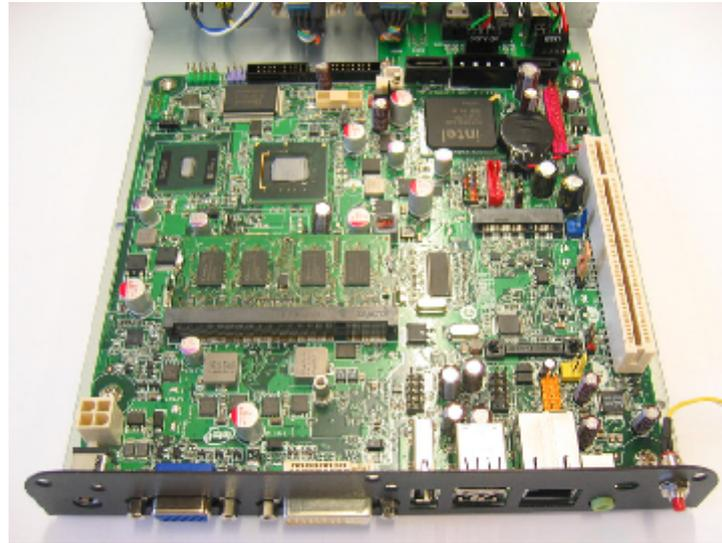
Schliessen Sie nun die Kabel POWER LED, POWER SW und HDD LED an
