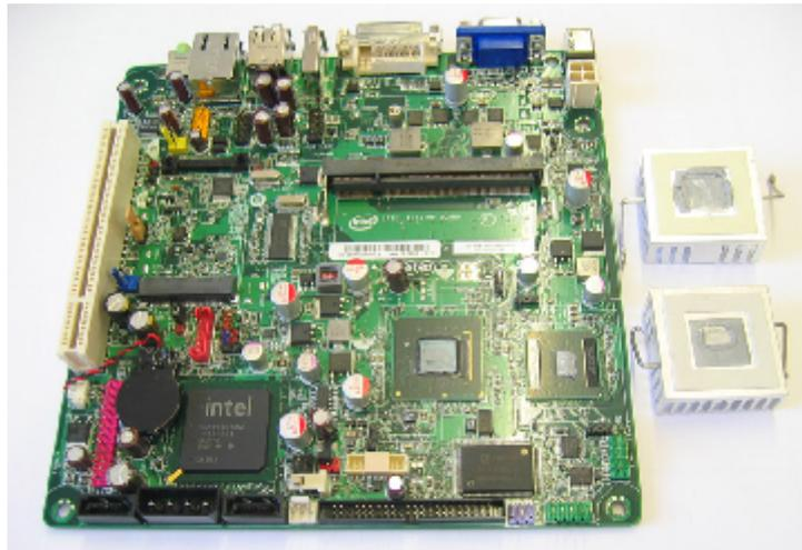
Entfernen Sie die Rückstände von der Wärmeleitpaste
