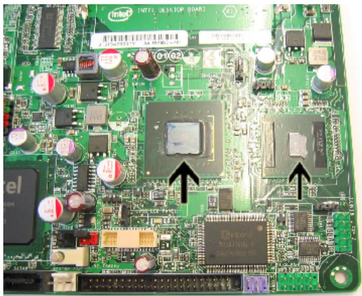
Tragen Sie die mitgelieferte Wärmeleitpaste in einer dünnen Schicht auf den Grafikchipset und die CPU auf
