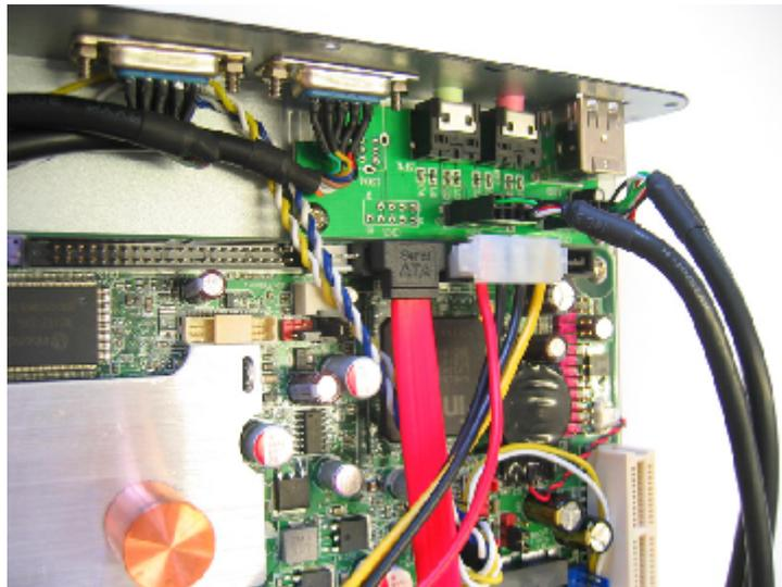
Verbinden Sie die Kabel mit der Festplatte
