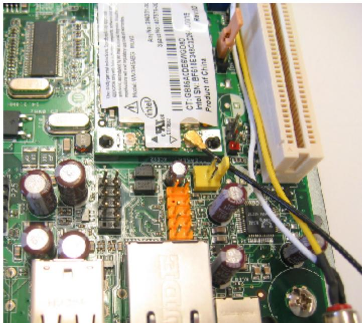
Um das Antennenkabel nach aussen zu führen, müssen Sie die Blende entfernen.
