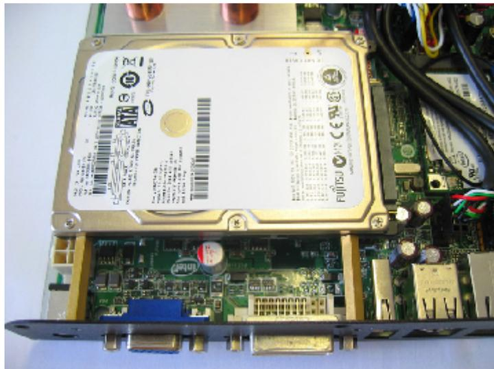
Ziehen Sie nun auf der anderen Seite die Schutzfolie ab und legen sie das Wärmepad auf die Festplatte
