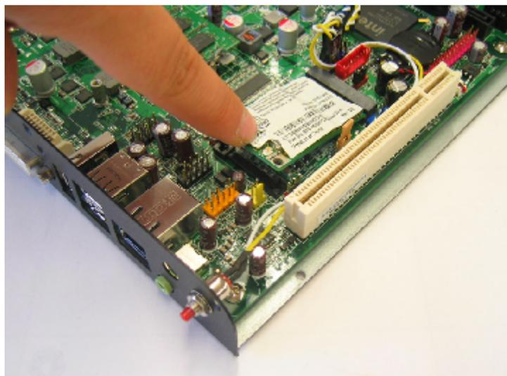
Das Antennenkabel schliessen Sie auf dem Steckplatz „MAIN“ an
