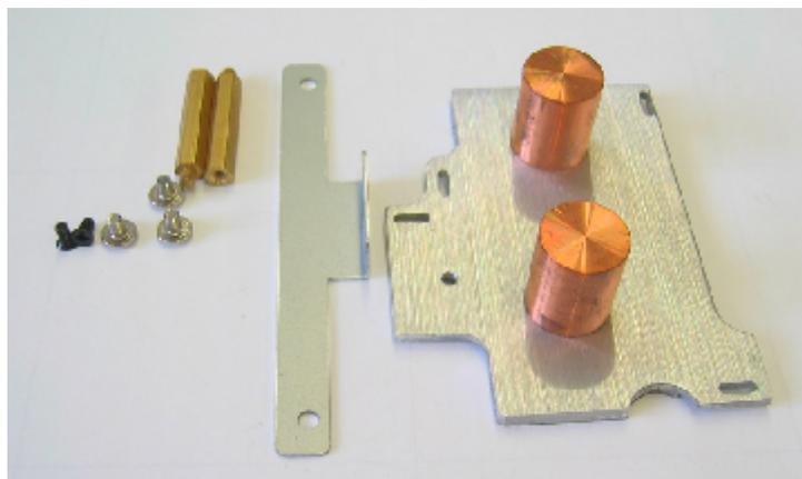
Schrauben Sie die Festplattenhalterung auf den Kühlkörper
