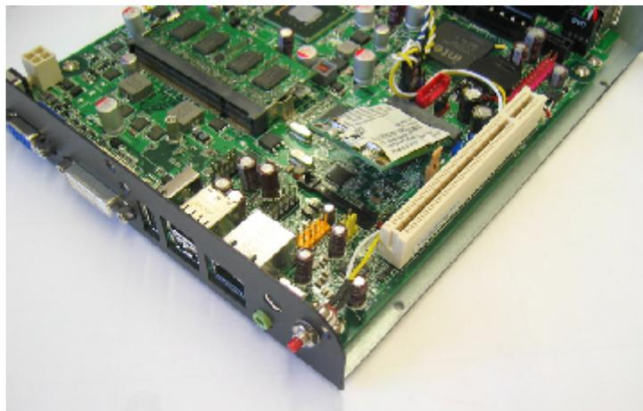
Drücken Sie die nach unten, bis die Wireless LAN Mini-PCI Express Modul eingerastet ist
