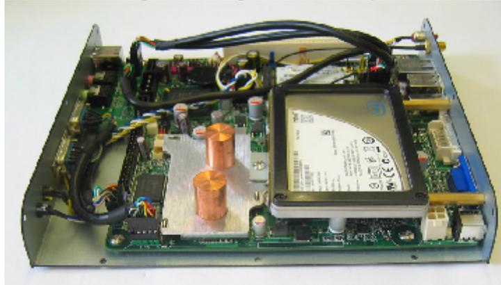
Nehmen Sie die beiden schwarzen Schrauben und befestigen Sie damit die Festplatte am Gehäuse
