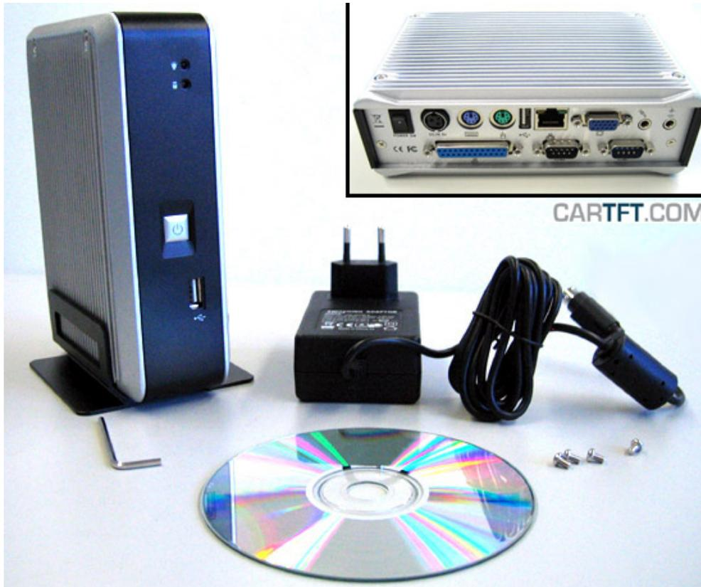
Mit dem beiliegendem Inbusschlüssel öffnet man die Inbusschrauben auf der Seite, bei der die COM-Ports, sowie der Parallellport am nächsten sind:
