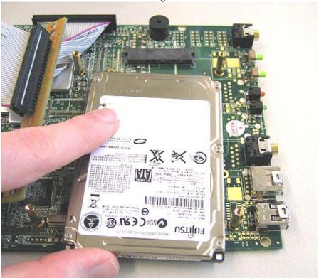
Auf der Rückseite des Mainboards wird die SATA HDD festgeschraubt:
