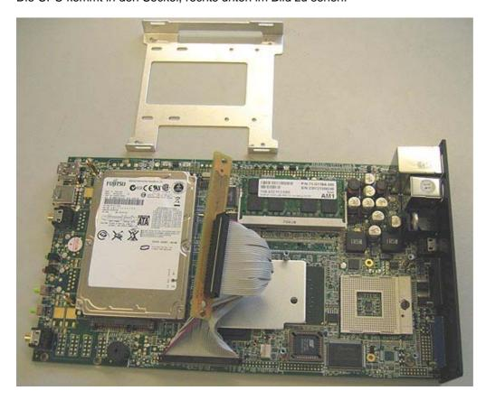
Man überprüft die Anordnung der Pins und setzt die CPU in den Sockel, so dass die CPU ohne Widerstand und Kraftaufwand in den Sockel versinkt. Danach schließt man mit einem Schlitzschraubenzieher das Sockel-Schloß. Die CPU-DIE mit ein bisschen (NICHT ZUVIEL) Wärmeleitpaste betupfen:
