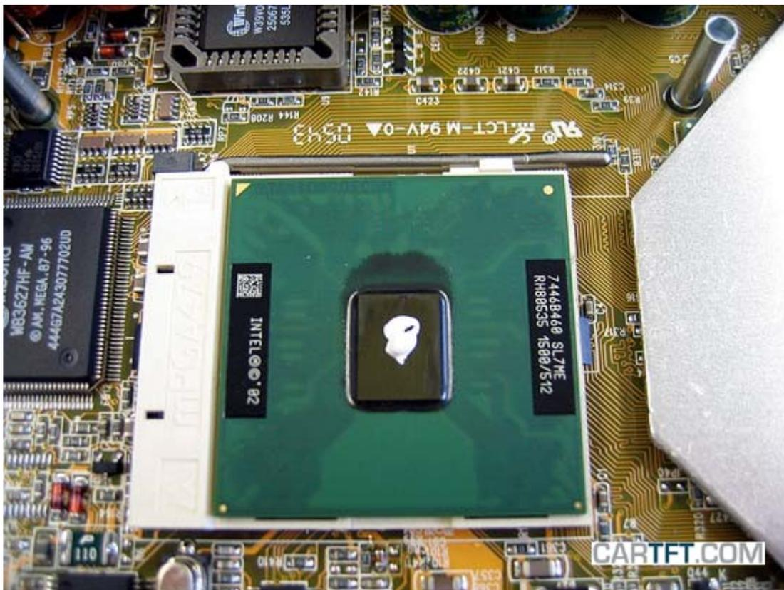
Dann vorsichtig den CPU Kühler aufsetzen, so dass alle Schraubengewinde durch die vorgesehenen Schraublöcher passen. Nun dreht man am besten kreuzüber die Schrauben leicht fest, damit nichts an der CPU beschädigt wird durch zu viel Druck auf einer Seite. Wenn alle 4 Schrauben passen, werden sie gleichmäßig festgedreht
