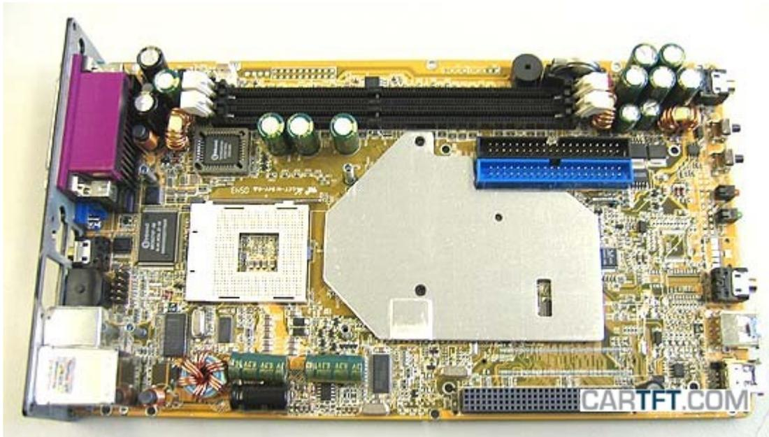
Einbau des Arbeitsspeichers erfolgt in der DIMM1 Bank:
