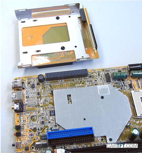
Die Halterungseinheit wird gedreht, um die kleinen, schwarzen Plastikverschlüsse zu entfernen:
