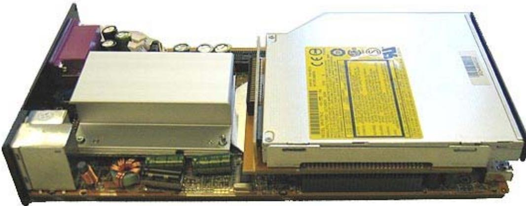
Bevor das Mainboard wieder in das Gehäuse eingeschoben wird, muss am Gehäuse noch die „Laufwerk“-Attrappenblende entfernt werden, damit später das richtige CD/DVD-Laufwerk benutzt werden kann.
