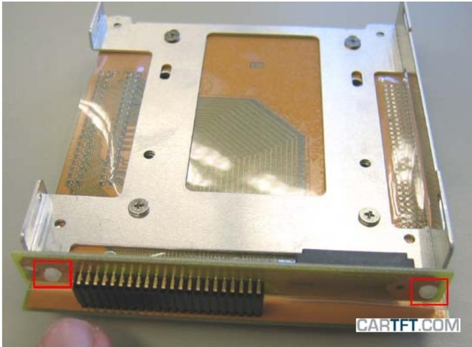
Anschließend kann man das CD/DVD-Laufwerk an den CD-ROM Adapter anschließen:
