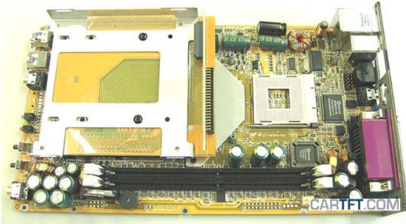
...und muss die Halterungseinheit für Festplatte und CD/DVD Laufwerk herausnehmen:
